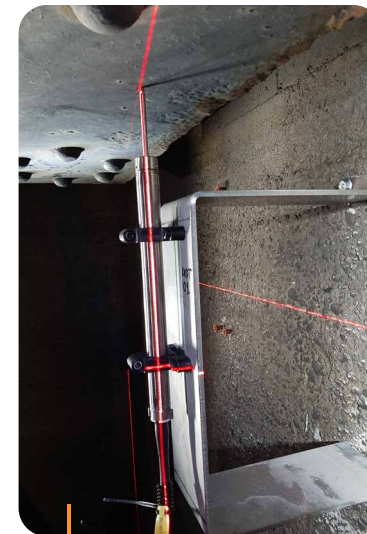
Verticaal gemonteerde verplaatsingssensor.
