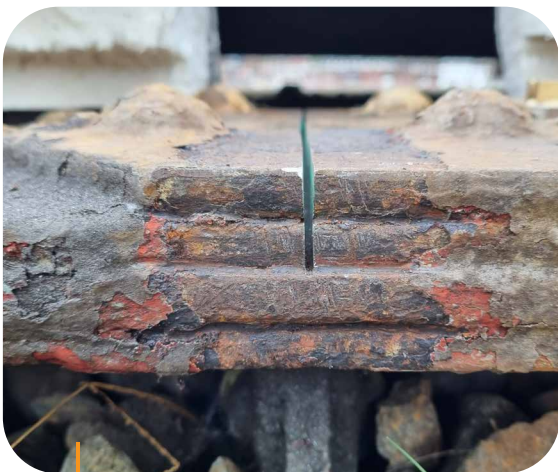
De aangebrachte scheuren in het proefproject van Ronse leidden tot een duidelijke invloed op de optische rekmodevormen.
